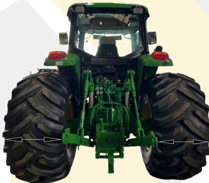
1. Após o acoplamento ao trator, em terreno firme e nivelado, observe a posição do implemento pela vista traseira;
