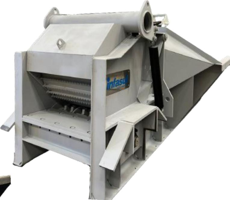
Projeto e fabricação da calha de entrada com sistema de correntes e rolo compactador.
