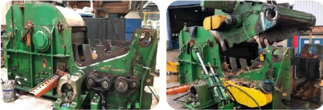
Projeto desenvolvido para alteração do sistema de alimentação do picador, passando de sistema pivotante frontal da capota superior dos rolos para o sistema com pivotamento central da capota juntamente com a substituição do conjunto de rolos pelo rolo compressor/compactador que maximiza a capacidade do equipamento em absorver materiais de maior volume.
