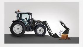
Tiene una válvula selectora con antichoque, que en caso de colisión, la misma se abre evitando roturas.
