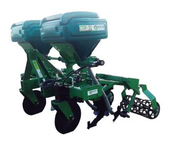
O equipamento **CTP - Cultivador Adubador EcoAgrícola** realiza simultaneamente várias operações, como a subsolagem, o destorroamento, a adubação e o corte da palhada (cultivo nas soqueiras), podendo ser utilizado tanto na cana crua quanto na cana queimada (ver kit's opcionais). Possui: dois discos de cortes de 20" (compacto) ou 24"
