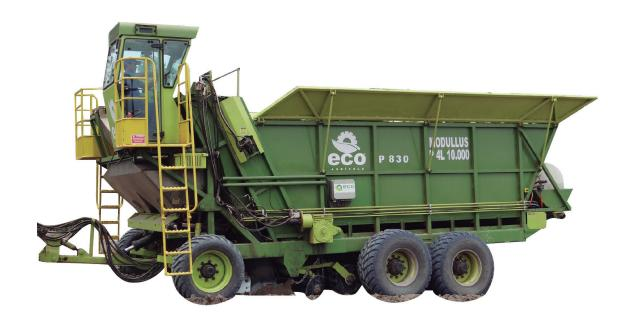
A **Plantadora Modullus EcoAgrícola** foi desenvolvida para atender o processo de mecanização do plantio de cana-deaçúcar, o equipamento destaca-se pela sua funcionalidade e alto desempenho operacional. Visando a otimização e redução de custos no plantio, o equipamento realiza as operações do plantio da cultura de uma só vez: abertura dos sulcos, distribuição do adubo, das mudas, aplica o inseticida, faz a cobertura dos sulcos e por último o acabamento do solo.
