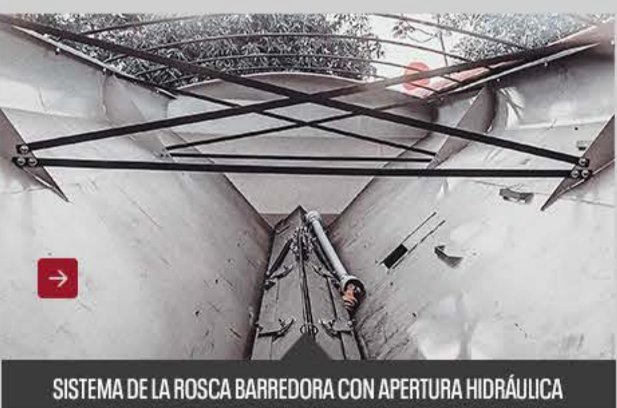
SISTEMA DE LA ROSCA BARRIDORA CON APERTURA HIDRÁULICA
