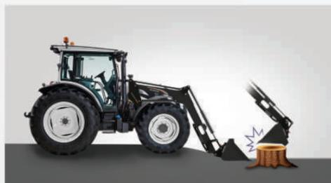
Tiene una válvula selectora con antichoque, que en caso de colisión, la misma se abre evitando roturas. Además posee una electroválvula que se acciona al presionar el pulsador del Joystick. Ésta desvía el flujo de aceite a otra línea para comandar el accesorio correspondiente al sistema de amortiguación.
