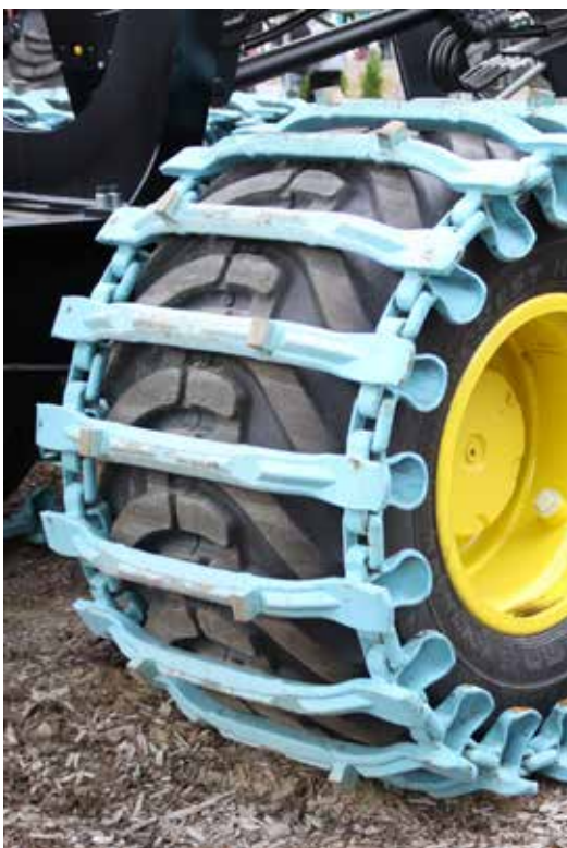
Fotografía cortesía de Olofsons AB. En la imagen se muestran unos orugos ECO-TRACS, modelo EVO-Soft.
